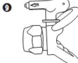
При использовании поворотного наконечника, поверните его в положение CLEAN
